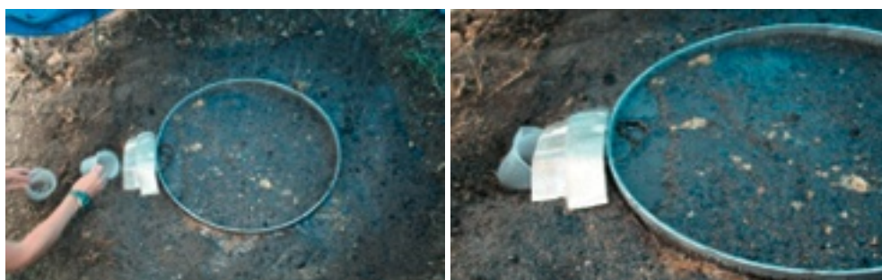
Figura 8. De izquierda a derecha se muestra el impacto de la lluvia simulada en una superficie cubierta por cenizas negras. La repelencia del suelo induce abundantes escorrentías que a su vez forman pequeñas presas con los materiales más gruesos (fotografía de la derecha). Este tipo de mediciones de precisión sólo se pueden hacer con lluvias controladas.
