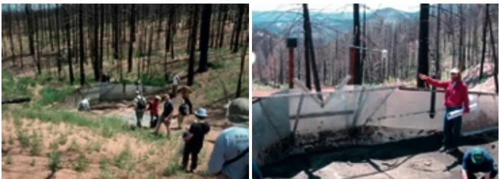
Figura 10. Visa general y detalle de los aforadores desarrollados por Peter Robichaud en las Montañas Rocosas, Colorado, EEUU.
