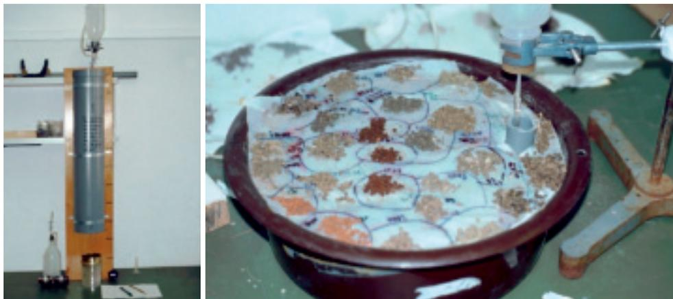
Figura 4. Equipo empleado para los Test CND (Counting the Number of Drop-impacts) y TDI (Ten Drops Impacts). Foto: Artemi Cerdà, Ámsterdam, 1991. A la izquierda, el tubo (200 mm) por el que caen las gotas y que permite que impacten sobre el mismo punto al evitar las corrientes de viento. Y a la derecha, recipiente con los agregados preparados a pH 1.
