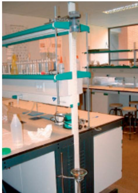
Figura 5. Simulador de lluvia empleado para el estudio de la estabilidad de agregados. Foto: J. Mataix-Solera, 2005.
