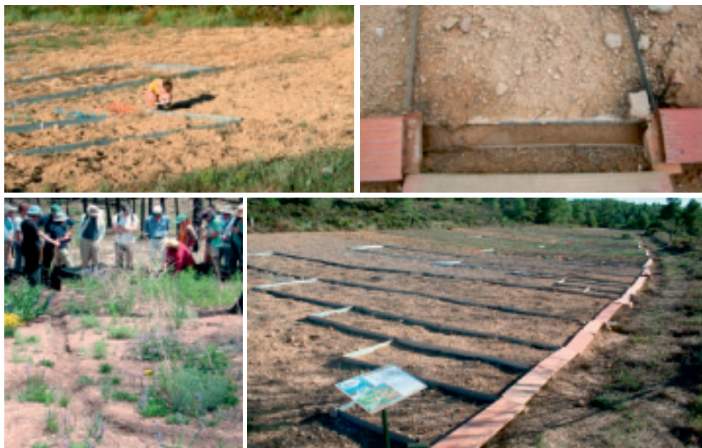
Figura 16. Arriba a la izquierda, trabajos de mantenimiento, en este caso el sellado de los delimitadores con silicona, Merche B. Bodí ejerce de escala. Arriba a la derecha, colector con sedimentos. En la parte inferior derecha vista general de las parcelas en la Estación Experimental para el Estudio de la Erosión del Suelo de El Teularet – Sierra de Enguera. Se puede apreciar como los delimitadores actúan sin alterar los suelos. Los delimitadores son de láminas de hierro galvanizado de 2000 mm x 200 mm y de 1,5 mm de espesor. Los colectores son de PVC cubiertos por material cerámico debido a los fuertes vientos de la zona, y los depósitos de 125 L que se conectan para poder almacenar hasta 500 L. En la parte inferior izquierda se muestra una parcela donde las zanjas actúan como delimitadores, en las parcelas de Lee H. MacDonald, Montañas Rocosas, Colorado. Fotografía David Scott.
