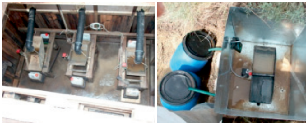
Figura 21. Vista de sistema automáticos de medición de caudal. El de la izquierda pertenece al de la Norwegian University of Life Sciences (ver figura 22), se encuentran en un sótano para evitar la congelación, y utilizan canijones de 5 L. El de la derecha pertenece a la Estación Experimental de El Teularet-Sierra de Enguera y cada canijón tiene una capacidad de 500 mL.
