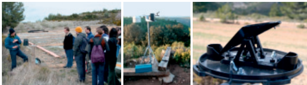
Figura 6. Las parcelas y las estaciones experimentales juegan un papel fundamental no sólo en la investigación, también en la docencia y la divulgación. A la izquierda vista de un pluviógrafo en la Estación Experimental de El Teularet-Sierra de Enguera durante la visita de un grupo de estudiantes, en el centro la estación experimental completa y a la derecha un detalle de los balancines del pluviógrafo.
