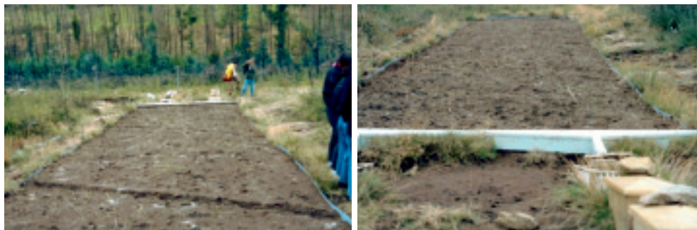
Figura 19. Vista de una parcela de erosión en Galicia. Toma desde la parte superior e inferior de la misma parcela. En la parte inferior se pueden ver los colectores que mediante divisores son capaces de almacenar una muestra adecuada de la arroyada.
