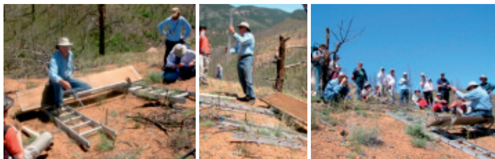
Figura 5. Levantamiento topográfico en parcelas afectadas por incendios forestales en las Montañas Rocosas, Colorado, EEUU. John Moody desarrolló este artilugio completamente transportable para cuantificar los cambios topográficos sin pisar el suelo. Fotografías Deborah Martin y José Reyes Ruiz Gallardo.
