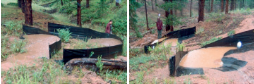
Figura 26. Trampas de sedimentos destinadas al estudio de la erosión del suelo en caminos. Fotografías Lee Harold MacDonald.
