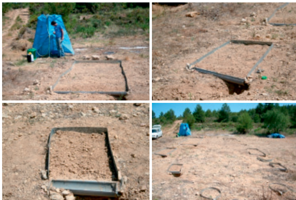
Figura 23. Vista de parcelas experimentales de distintos tamaños en la Estación Experimental para el Estudio de la Erosión del Suelo de El Teularet – Sierra de Enguera. De izquierda a derecha y de arriba abajo, parcelas de 2 \times 6 \text{ m} , de 1 \times 2 \text{ m} y de 0,6 \times 1,20 \text{ m} y una vista general de parcelas de distintos tamaños en las que en la parte inferior se puede ver parcelas circulares de 0,24 \text{ m}^2 . En la primera y última imagen Paulo Pereira ejerce de escala.
