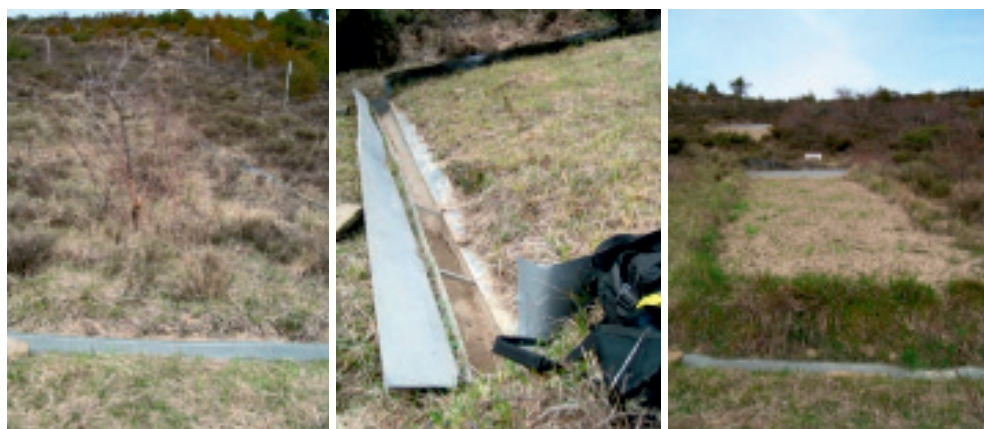
Figura 13. Parcelas de 5 x 10 m de la estación experimental del Instituto Pirenaico de Ecología en Aísa, Consejo Superior de Investigaciones Científicas, provincia de Huesca. De izquierda a derecha una parcela afectada por un incendio (se aprecian a un los restos de Rosa canina ), detalle del colector de la parcela dedicada al prado y parcela con laboreo. Fotografías de Deborah Martin (USGS; Boulder, Colorado, EEUU).
