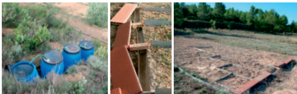
Figura 20. Vista de los colectores conectados en la Estación Experimental para el Estudio de la Erosión del suelo de El Teularet-Sierra de Enguera. A la izquierda los depósitos donde llegan los materiales con textura más fina, en el centro los colectores donde queda el material más grueso, y a la derecha vista de la parcela de laboreo tradicional.
