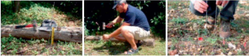
Figura 1. Materiales básicos para la instalación de una red de medición de la erosión del suelo mediante agujas, piquetas, varillas o clavos de erosión. Una maza, piquetas de acero (50 cm de altura y 3,5 mm de diámetro), como se muestra en la fotografía de la izquierda, y una cinta métrica. Vista de la forma de instalarlas y un ejemplo de cómo quedan tras cortar la piqueta sobrante. Ver marcas con cinta aislante roja en la fotografía de la derecha y comparar con la piqueta original sostenida en las manos de Artemi Cerdà.
