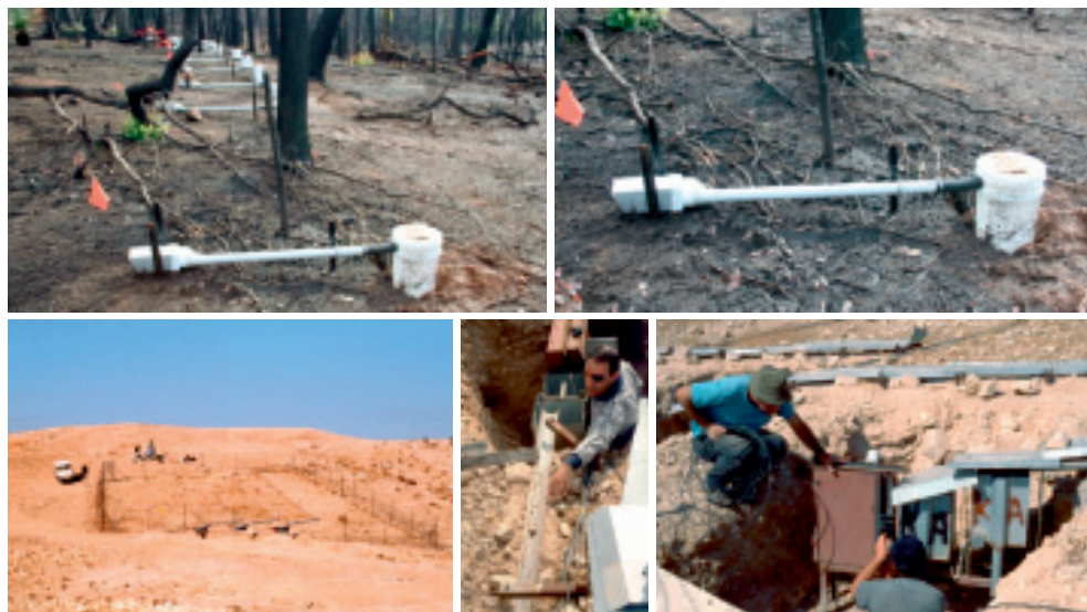
Figura 9. Arriba, vista de los colectores desarrollados por Gary Sheridan de la University of Melbourne (Australia). El colector es de tan sólo 200 mm de tamaño y la repetición de esta parcela permite conocer la variabilidad espacial de la escorrentía. Abajo, vista de las parcelas de la estación experimental de Kalía, y detalle de los colectores con divisores utilizados por Hanoch Lavee en sus estudios a lo largo de gradientes climáticos en el Desierto de Judea.
