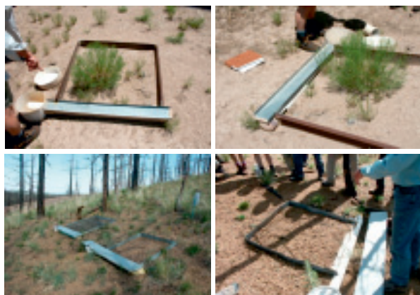
Figura 11. Parcelas de 1 × 1 m utilizadas por Craig Allen del Bandelier National Park en New Mexico (EEUU) y abajo las empleadas por John Moody en las Montañas Rocosas, Colorado (USGS Boulder) para estudiar suelos afectados por incendios forestales. Parcelas cerradas con colector de PVC (tubo con tapas laterales y ranura de entrada de agua), cubierta protectora del colector de hierro galvanizado, delimitadores de hierro y depósito de PVC.
