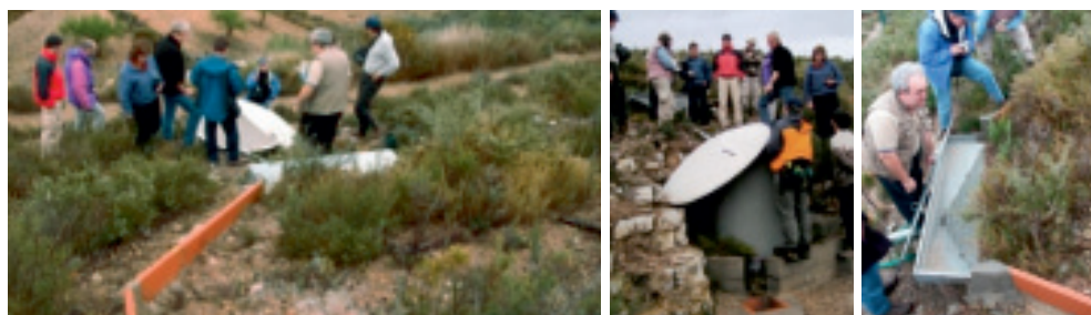
Figura 14. Detalle de los colectores y depósitos de las parcelas (4 x 20 m 2 ) de la estación experimental de la Concordia. A la izquierda vista del tramo final de la parcela con el colector. En el centro el depósito y a la derecha detalle del colector al que Vicente Andreu ha retirado amablemente la tapa. Centro de Investigaciones sobre Desertificación, Consejo Superior de Investigaciones Científicas, Valencia. Fotografías: Reyes Ruiz Gallardo, Universidad de Castilla – La Mancha.
