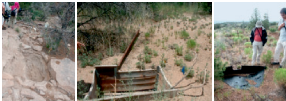
Figura 7. Vista de tres tipos de colectores utilizados por Craig Allen en la estación experimental del Bandelier National Park. De izquierda a derecha, una poza natural donde se decantan los sedimentos después de pasar por el aforador, una poza artificial construida con tablonces de madera, y una trampa de sedimentos construida con material plástico. Xavier Úbeda y Fernando Pérez Cabello ejercen amablemente de escala.
