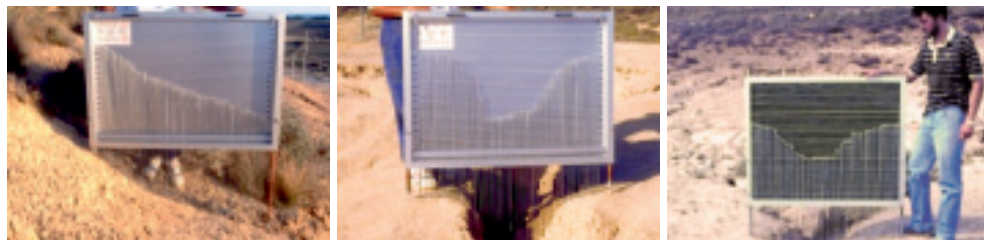
Figura 4. Ejemplos de perfiladores utilizados en las estaciones experimentales de Lanaja y Castillo de Orús en Aragón. Estos instrumentos se han utilizados en regueros y entreregueros. A la derecha Gerardo Benito ejerce de escala. Fotografías: Carlos Sancho, Universidad de Zaragoza.
