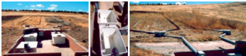
Figura 15. De izquierda a derecha, vista general de dos parcelas y depósitos, detalle de los depósitos y colectores en el centro, y a la derecha vista de los tubos que comunican los colectores con los depósitos en la estación de la Higuera en Santa Olalla en Toledo.
