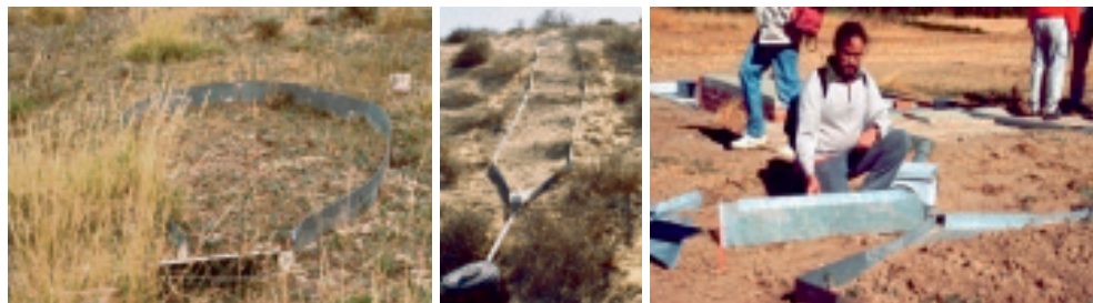
Figura 12. A la derecha vista de una parcelas circular cerrada (3 m 2 ) utilizada por Purificación Ruiz-Flaño a principios de los años 90 en su Tesis Doctoral. Fotografía Teodoro Lasanta. En el centro parcela cerrada en el campo de dunas de Nizzana, Israel. Y a la derecha detalle del colector de las parcelas cerradas de la estación de la Higuera en Santa Olalla en Toledo. Saturnino de Alba ejerce de escala.
