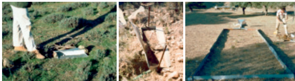
Figura 8. Vista de parcelas abiertas y cerradas. A la izquierda parcela abierta y a la derecha parcela cerrada en la estación experimental de Guadalperalón en Extremadura. Antonio Ceballos, Universidad de Salamanca, ejerce de escala en ambas. En el centro caja Gerlach de la estación experimental de Requena (Fotografía Neus La Roca).
