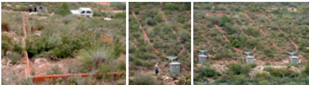
Figura 18. Vista de las parcelas ( 4 \times 20 \text{ m}^2 ) de la estación experimental de la Concordia. Centro de Investigaciones sobre Desertificación, Consejo Superior de Investigaciones Científicas, Valencia. Destacan los delimitadores realizados mediante obra de albañilería y los depósitos de gran capacidad. Fotografías: Reyes Ruiz Gallardo, Universidad de Castilla – La Mancha y Deborah Martin (USGS; Boulder, Colorado, EEUU).
