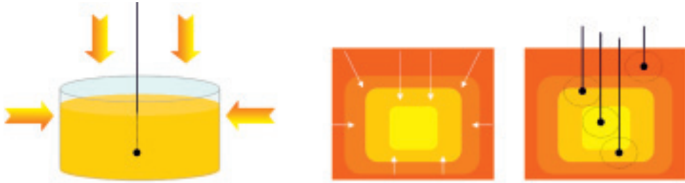
Figura 5. Izquierda: muestra de suelo introducida en un horno-mufla, en la cual se ha introducido un termopar. Centro: corte transversal de la muestra durante el quemado. Cada color indica una temperatura (las flechas blancas la penetración del calor). Derecha: corte transversal en donde se muestra que la lectura del termopar no es representativa de la temperatura de la masa de suelo. La lectura del termopar sólo se corresponderá con la temperatura de volúmenes de suelo cercanos a la punta del termopar. En función de donde coloquemos el termopar, éste dará una lectura distinta.
