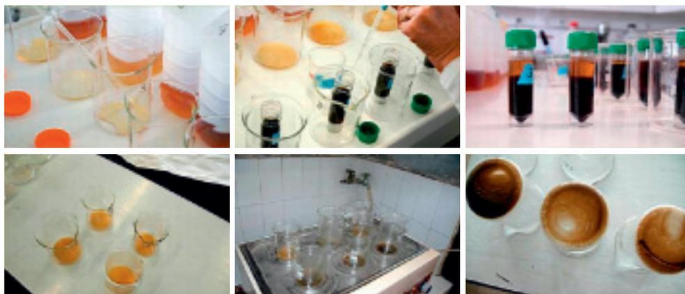
Figura 7. Valoración cuantitativa de las fracciones de extracto total (ácidos húmicos y ácidos fúlvicos): Toma de alícuotas del extracto total; toma de alícuotas para ser precipitadas a pH=1 y centrifugadas; ácidos húmicos redissueltos en NaOH; desecación al baño; muestras desecadas preparadas para valoración de C.
