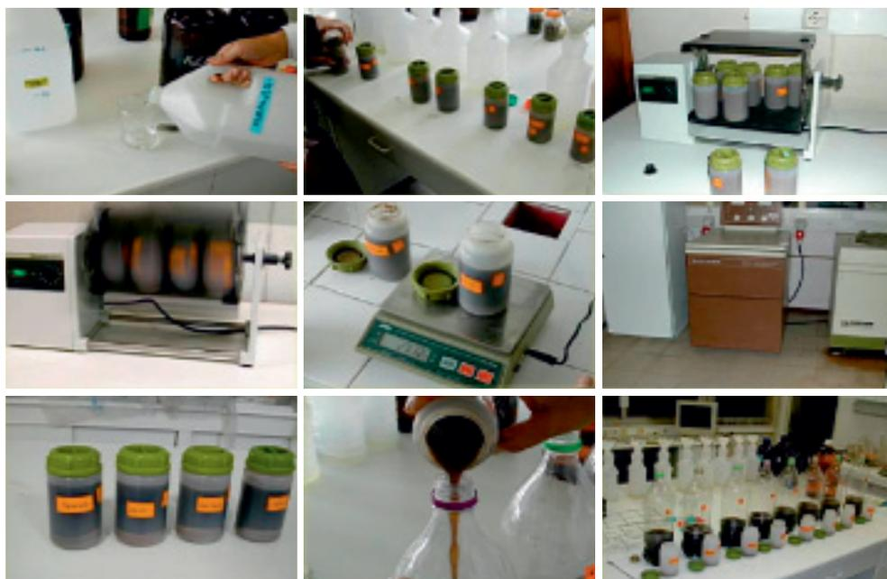
Figura 3. Separación de la materia orgánica libre de densidad comprendida entre 1,1 y 1,8. Suspensión del suelo en mezcla de bromoformo con alcohol, centrifugación, separación por filtración, desecación en estufa, pesada.
