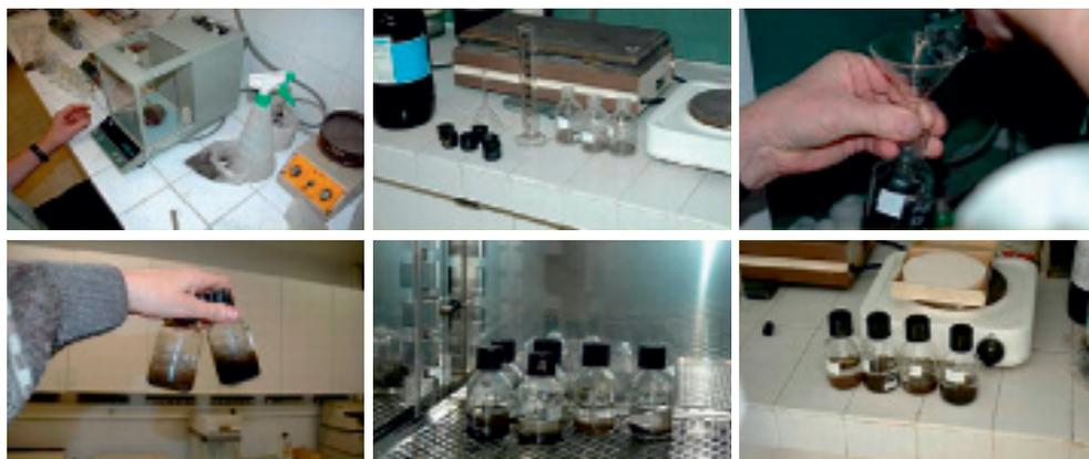
Figura 4. Extracción de lípidos en discontinuo en frascos cerrados en estufa a 60 °C: Tratamiento con diclorometano-metanol; agitación y extracción en estufa previa a filtración y evaporación del solvente.
