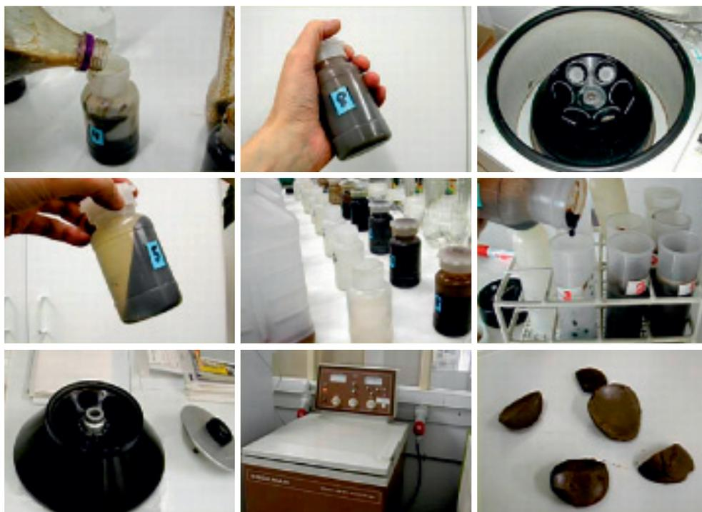
Figura 8. Eliminación de arcillas en de ácidos húmicos; precipitación a pH ácido; redisolución de los ácidos húmicos en NaOH 0.5M; ultracentrifugación a ~20000 rpm para sedimentar la arcilla y otros coloides insolubles en NaOH.
