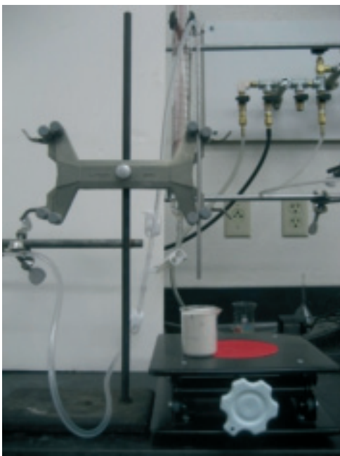
Figura 8. A la izquierda sonda de sortividad utilizada para determinar la sortividad en muestras pequeñas. Se aprecia el uso de una pinza (scissor Jack) para elevar la muestra a la sonda. A la derecha Columna utilizada para determinar las propiedades de retención hídrica de ceniza en un rango de potenciales que van desde 0 a 0,1 bares.
