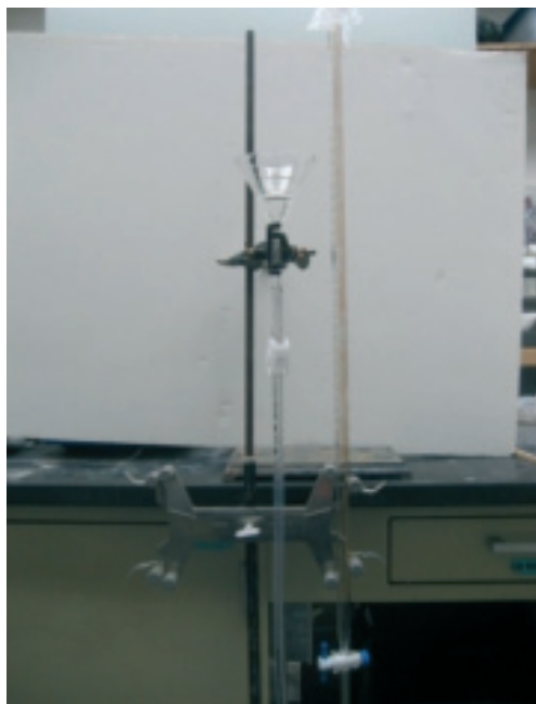
Figura 8. A la izquierda sonda de sortividad utilizada para determinar la sortividad en muestras pequeñas. Se aprecia el uso de una pinza (scissor Jack) para elevar la muestra a la sonda. A la derecha Columna utilizada para determinar las propiedades de retención hídrica de ceniza en un rango de potenciales que van desde 0 a 0,1 bares.
