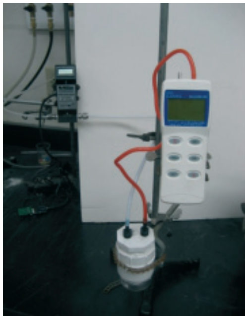
Figura 7. Instrumentos utilizados para las mediciones de permeabilidad. Célula de flujo, manómetro y medidor de flujo.
