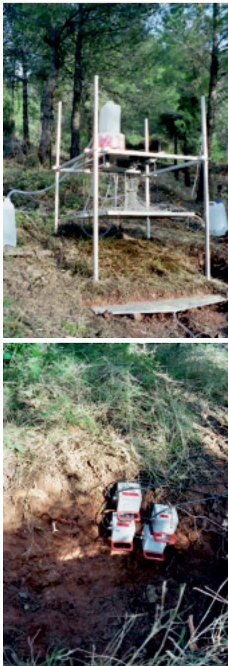
Figura 18. A la derecha, vista del simulador goteador utilizado, y a la izquierda sondas TDR instaladas a distintas profundidades del suelo.
