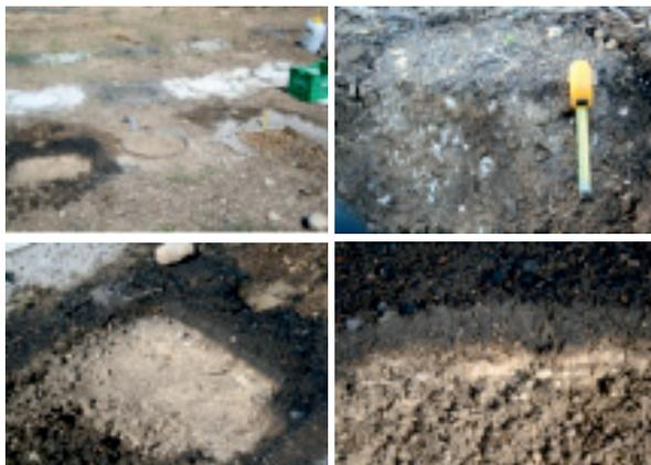
Figura 5. De izquierda a derecha y de arriba abajo, se puede observar la excavación de los frentes de humedad y detalles de los mismos en experimentos desarrollados en julio de 2010 con distintos tipos de ceniza por Merche B. Bodí y Francisco Javier León Miranda.
