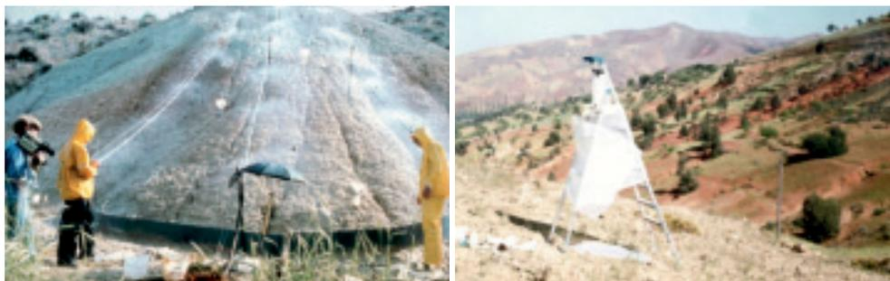
Figura 3. Simuladores de lluvia. Simulador de lluvia con aspersores desarrollado por el grupo del *Fysisch Geografisch Bodemkundig Laboratorium* de la Universiteit van Amsterdam para sus estudios en Badlands en España. A la derecha un simulador de lluvia construido improvisadamente para su uso en Marruecos. Una escalera y un protector de viento fueron suficientes para desarrollar el instrumento. Fotografías de Anton Charles Imeson.
