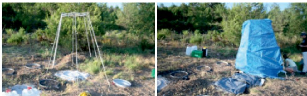
Figura 6. Vista del simulador de lluvia (Cerdà et al., 1997) con modificaciones en la estructura introducidas para experimentos diseñados por Merche B. Bodí y Francisco Javier León Miranda. A la izquierda se puede ver la nueva estructura de 8 apoyos y a la derecha con la cubierta protectora del viento.
