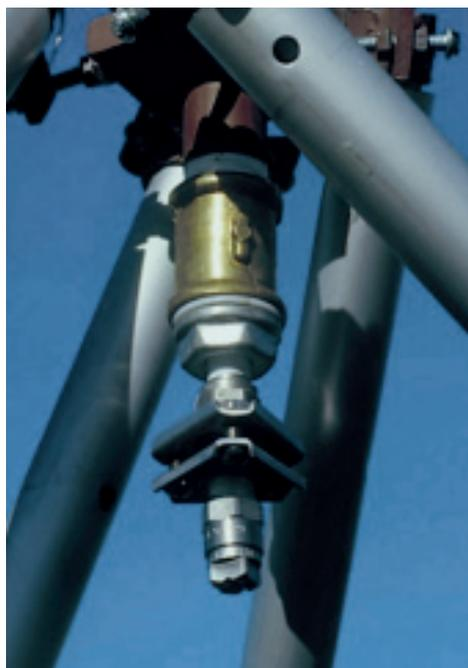
Figura 14. Vista general del simulador de lluvia utilizado en el experimento 4 y detalle del sistema formador de lluvia utilizado por Benito et al. (2001).
