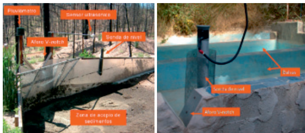
Figura 3. Aforos de tipo V-notch instalados en cuencas experimentales en Colorado (EEUU) y Alicante (España). Se muestran los elementos estructurales más relevantes y diversos instrumentos de medida.
