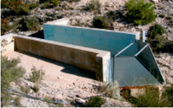
Figura 4. Aforo de tipo H-Flume en una cuenca experimental en Alicante (España).
